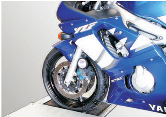
Fig. 97 – Kontrollimi i forcës së frenimit me valakë (brekon) për motoçikleta
