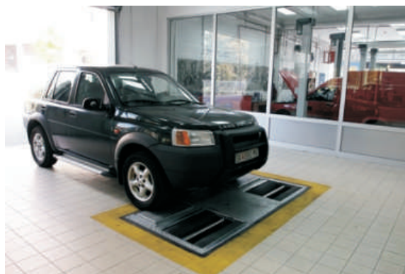
Fig. 95 – Kontrollimi i forcës së frenimit me valakë (brekon)
